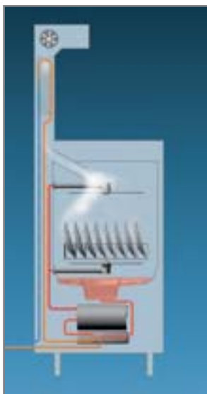
Schematische Darstellung Wärmerückgewinnungsprozess GS 502 Energy + (bei Kaltwasseranschluss).
